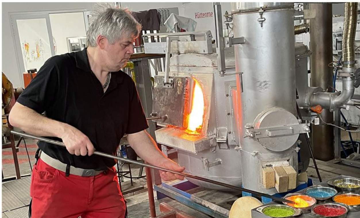
Glasmacher Michael Mielitz taucht die Pfeife mit heißer transparenter Glasmasse in Pulver aus Farbglas. Im Schmelzofen wird es bei 1200 Grad verbacken.
